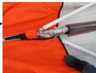
Fig. 2 Montant droit du trapèze désolidarisé de son accrochage à l'aile
